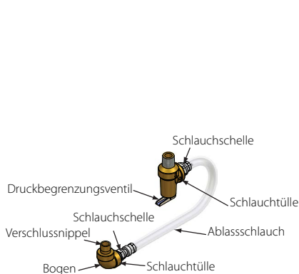
Details zum optionalen Druckbegrenzungsventil
