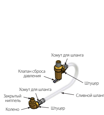
Детальное изображение дополнительного комплекта клапана сброса давления
