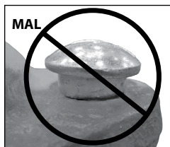
CUELLO OVALADO DEL PERNO ASENTADO INCORRECTAMENTE
