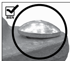
CUELLO OVALADO DEL PERNO ASENTADO CORRECTAMENTE
